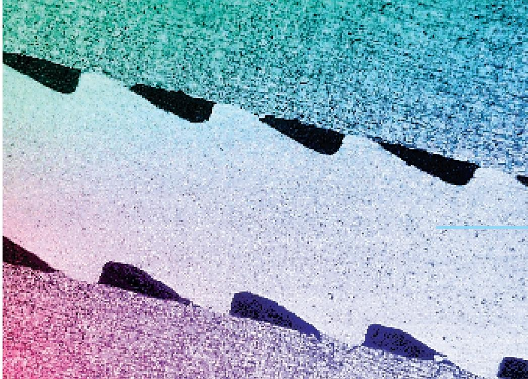
Abb. 2: Schnitt durch eine Verschraubung mit SCHNORR-Sicherungsscheibe
