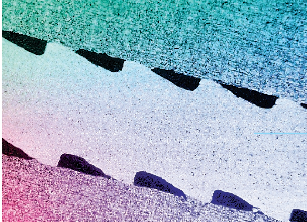
Abb. 2: Schnitt durch eine Verschraubung mit SCHNORR-Sicherungsscheibe Fig. 2: Transverse section of a bolted connection with SCHNORR Safety Washer
